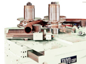
パイプ曲げ Bending pipe
